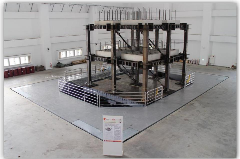
◆ 雙軸向動態測試系統(BATS)：是亞洲唯一、世界唯三可供隔震元件進行足尺寸動態試驗的實驗設備。
